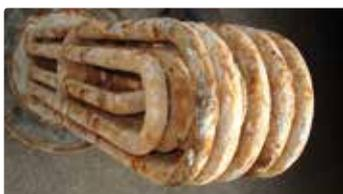
Scambiatore di calore a tubo
